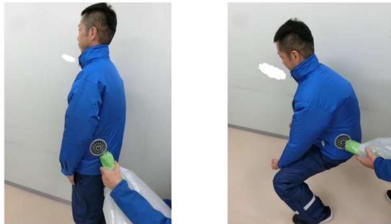
スモークマシンのスモークを袋に溜め、活動中にファンから流入させPM値を測定
